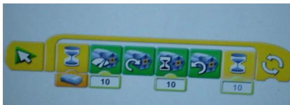
Была использована программа управления роботом, которая состоит из перетаскивания стандартных «иконок» управления мотором. Алгоритм управления – циклический. Датчик движения «ждет», когда очередной груз попадет в ковш машины, при этом срабатывает датчик движения, (он реагирует на движение груза), начинает работать мотор и ковш, с грузом, поднимается и сбрасывает груз в кузов машины, за тем мотор вращается в обратную сторону и ковш опускается и ждет поступления следующего груза.
