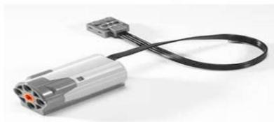
Можно запрограммировать направление вращения мотора (по часовой стрелке или против) и его мощность. Питание на мотор (5В) подаётся через USB порт компьютера. К мотору можно подсоединять оси или другие LEGO-элементы.
